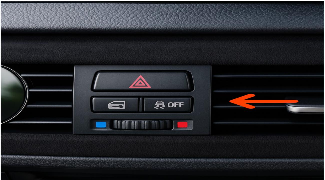
Der Luftauslass ist mit zwei 8-mm-Muttern sowie mehreren Clips an der Zierleiste fixiert.
