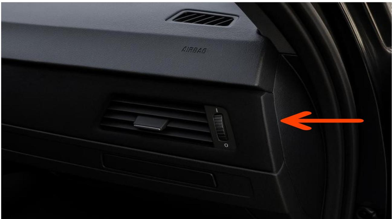
Die Leiste wird vorsichtig weiter in Richtung Lenkrad gelöst. **Wichtig:** Der Startknopf und die Schaltereinheit am Luftauslass sind noch per Kabel mit dem Armaturenbrett verbunden – also nicht ruckartig ziehen.
