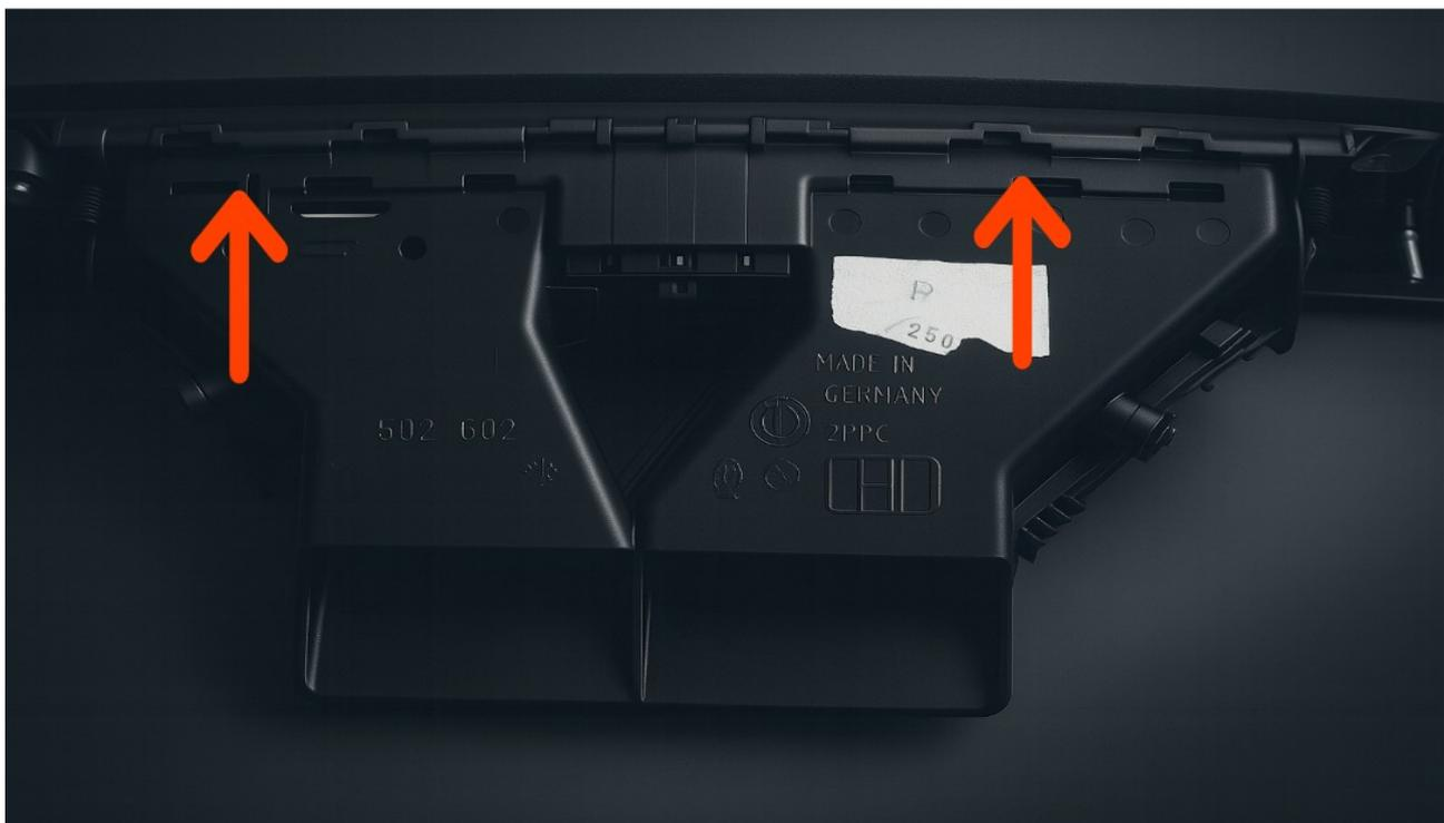
Nun lässt sich die Abdeckung unter dem Handschuhfach demontieren. In der Regel sind auf jeder Seite zwei Torx T20-Schrauben verbaut, die zuvor entfernt werden müssen.
