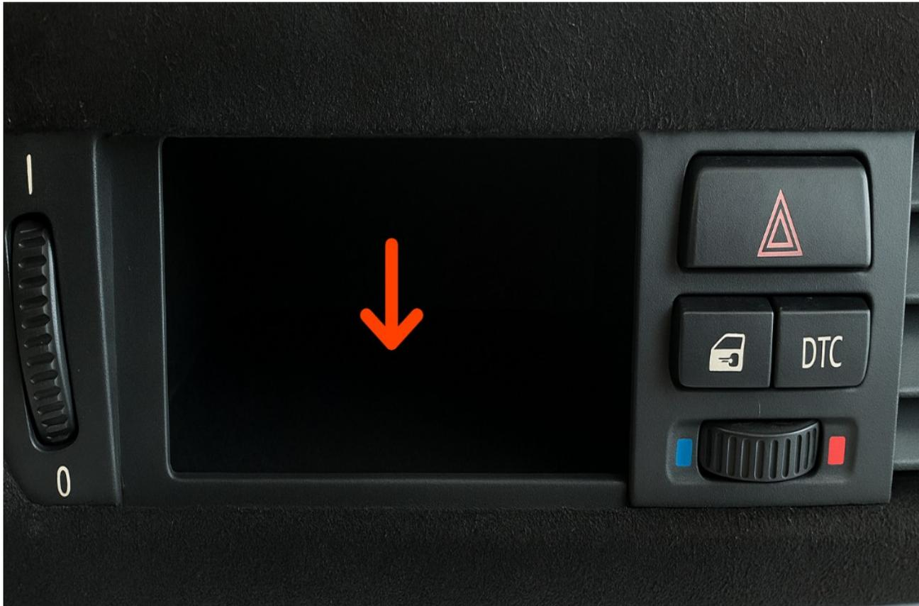
**Auf der Unterseite muss eine Bohrung gemacht werden, um den Display-Anschluss durchzuführen.**
