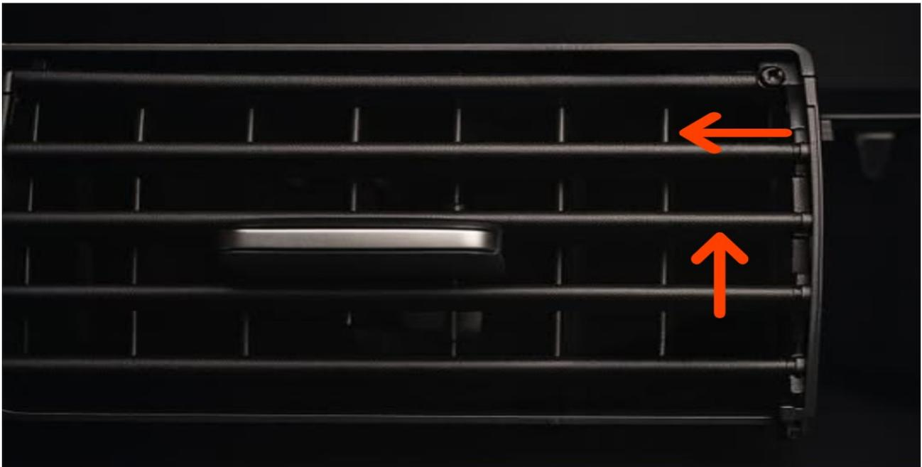
Die Frischluftgitter müssen zunächst ausgebaut werden. Danach wird das innere Gitterelement aus dem Rahmen entfernt.
